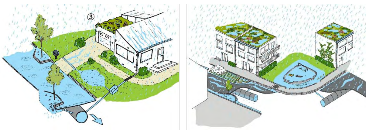
Figuur 10. Extreme neerslagafvoer: gecontroleerd overstromen © Aquafin.
