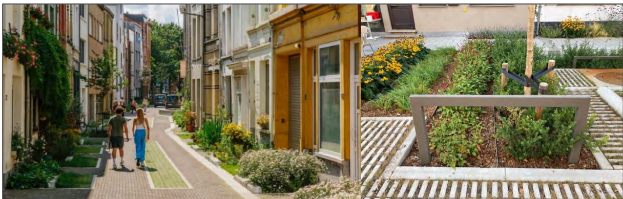
Figuur 15. Vlnr: (1) ontharding met boven- en ondergrondse infiltratie in centrum Antwerpen (© Aquafin); (2) Infiltrerende plantvakken in Aziëlaan (tuinstraat Wilrijk).
