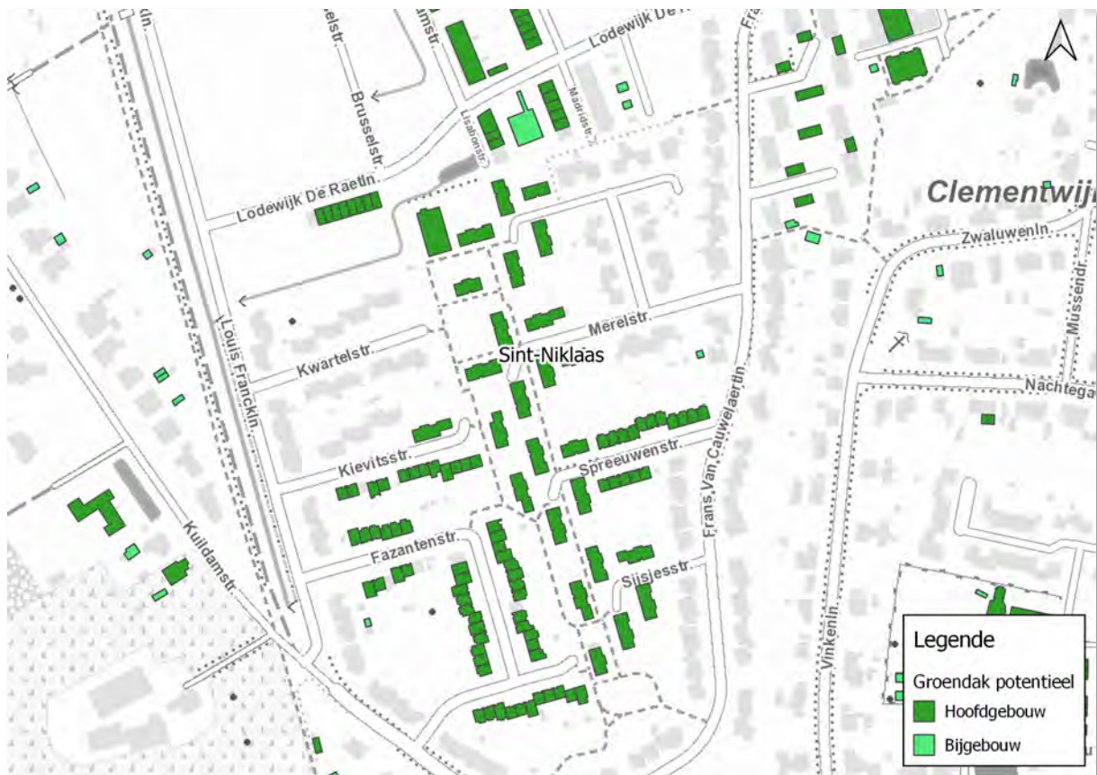
Figuur 31: Zoom van de kansenkaart met het potentieel voor groendaken in de stad Sint-Niklaas.
