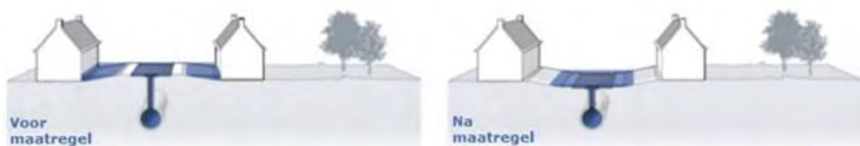
Figuur 24: Principeschets van bergen op straat (bron: RIONED).
